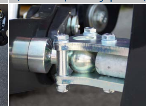
Opcja 2: Zaczep kulowy (z możliwością dowolnego położenia)
