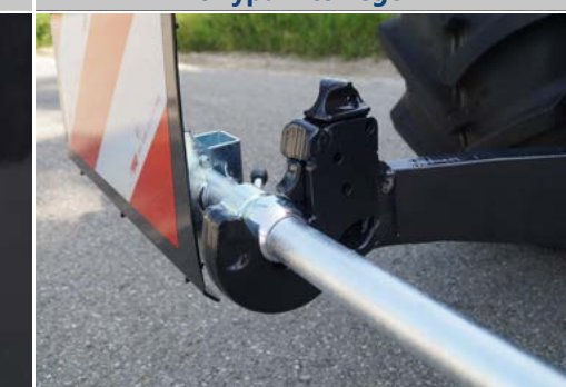
Opcja 3: Układ zawieszenia trzypunktowego
