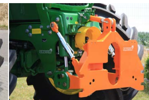
Płyty komunalne – mocowanie za pomocą dolnych cięgien (wersja sztywna)
