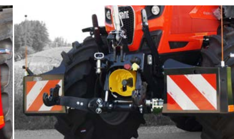
Opcja 2: Zaczep kulowy (z możliwością dowolnego położenia)
