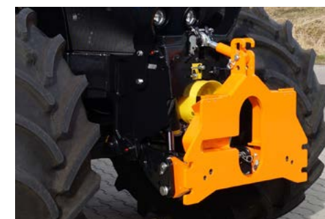
Płyty komunalne – mocowanie za pomocą dolnych cięgien
