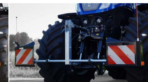
Opcja 3: Układ zawieszenia trzypunktowego
