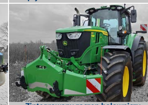
Zintegrowany zaczep holowniczy (10 t uciągu)
