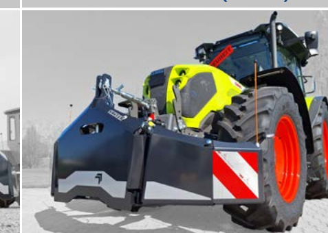
Wyposażony w lampy obrysowe LED oraz tyczki obrysowe
